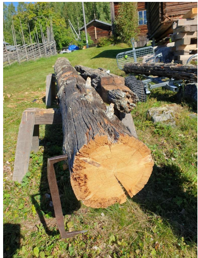
2022-08-24: Den nya stocken är en fura som har dött på rot. Kärnandelen är stor.
